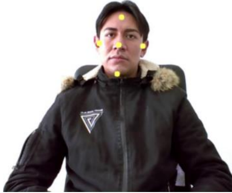
Fig. 3. Puntos seleccionados con mediapipe para rastrear el movimiento.
